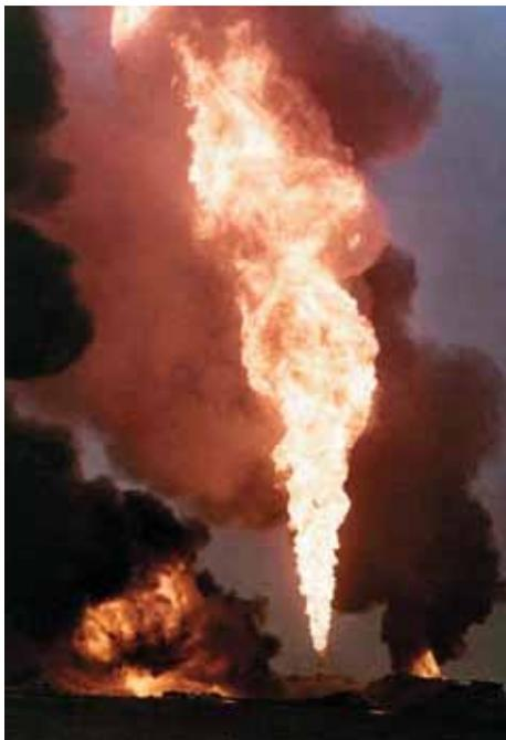
Вид основного факела, приподнятого на 6 м от земли после наведения превенторной сборки с помощью гидронатаскивателя
