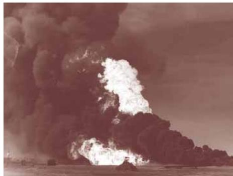
Пламя газовых струй вследствие наличия в устье скважины обрушенного оборудования имело распыленную форму
