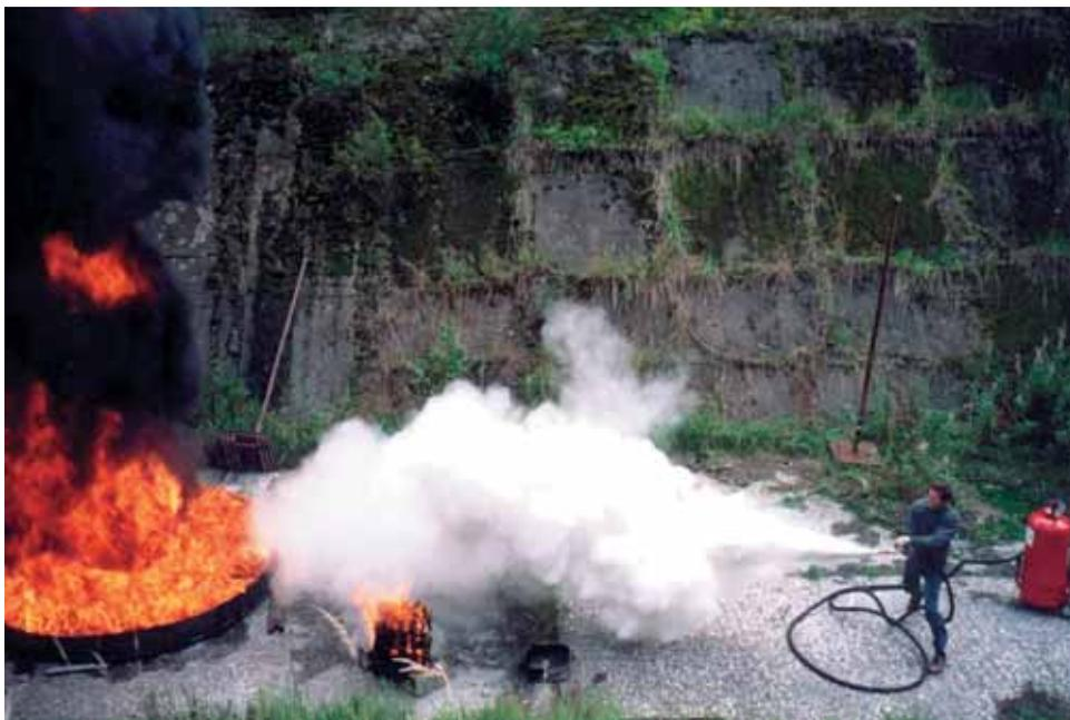
Рис. 5. Работа огнетушителя ОП-100 (г)
