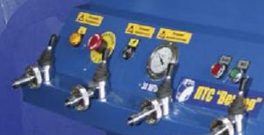
**ПТС «ВЕКТОР»-210/265** Переносные компрессоры производительностью 210 или 265 л/мин и рабочим давлением 30,0 МПа.
