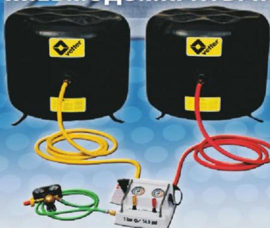
Предназначены для равномерного подъёма крупногабаритных и легко разрушаемых объектов на значительную высоту. Грузоподъёмность одного домкрата - от 3 до 11,3 тонны при весе от 7 до 21 кг соответственно (в зависимости от модели). Максимальная высота подъёма - 110 см (Type 1/23).
