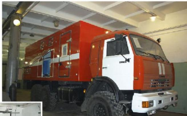
Компрессорная станция ПКС-2000-300 на базе шасси «КАМАЗ»
