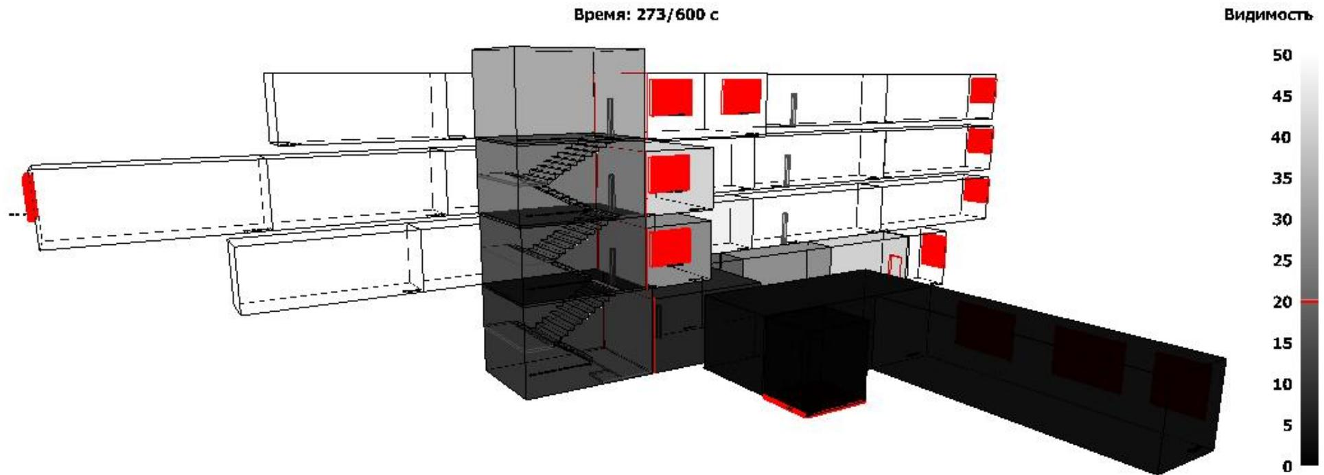
Рис. 16. Распространение дыма по зданию Администрации через 273 секунды с момента возникновения пожара
