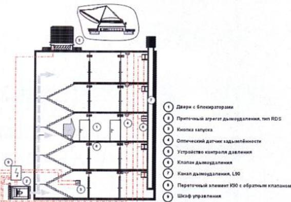
Схематическое изображение подпорной системы дымоудаления с автоматическим сбросом давления и обеспечением оттока с этажа эпицентра пожара
