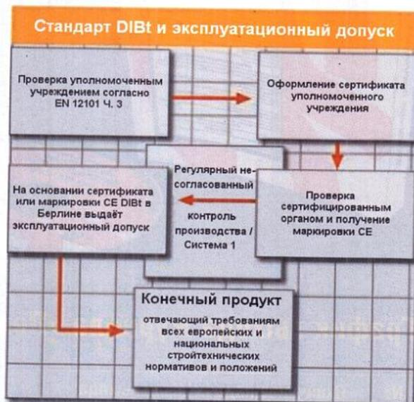
Рис. 1. Вентиляторы дымоудаления разрешены к применению только при наличии комбинации разрешений CE и DIBt
