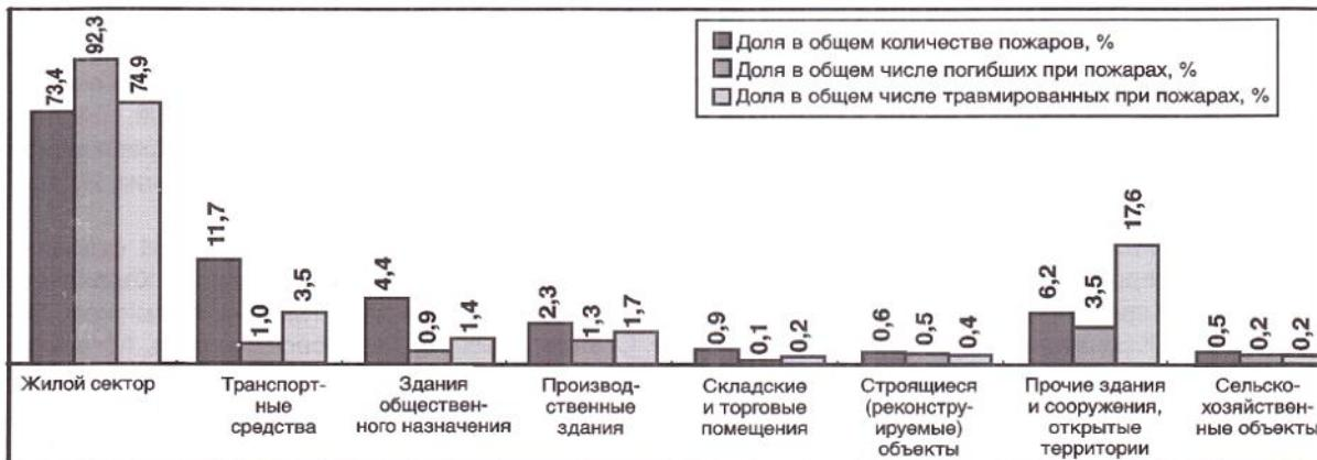
Рис. 1. Распределение количества пожаров, числа погибших и числа травмированных при них людей по основным видам объектов пожара
