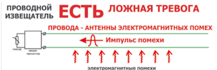
Рис. 6. Воздействие электромагнитных помех на проводные пожарные извещатели
