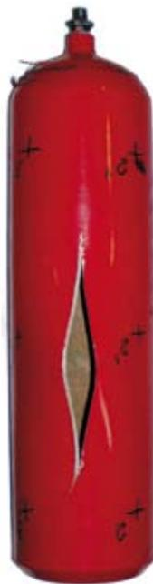
**Рис. 1. Разрушение баллона типа 1 на цилиндрическом участке в виде осевой трещины**
