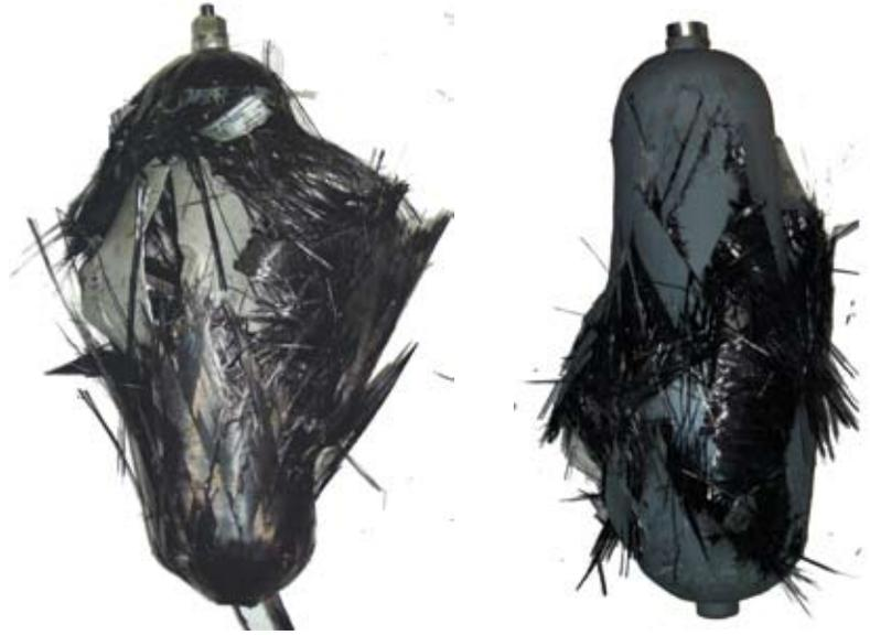
Рис. 3. Безосколочное разрушение баллона с тонкостенным металлическим лейнером и обмоткой типа «кокон»
