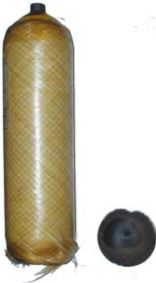
Рис. 2. Разрушение баллона с кольцевой обмоткой с вылетом днища
