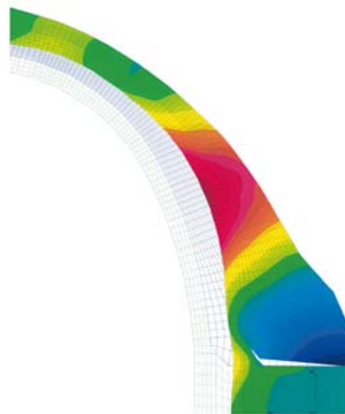
Рис. 7. Распределение деформаций по толщине слоистого пакета на днище баллона с намоткой типа «кокон»
