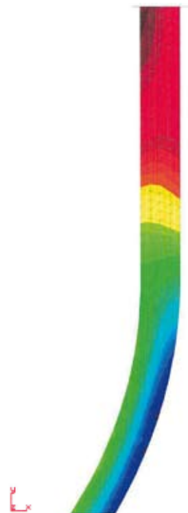
Рис. 1. Распределение интенсивности напряжений на участке сопряжения цилиндрической части и стандартного выпуклого днища гладкого баллона
