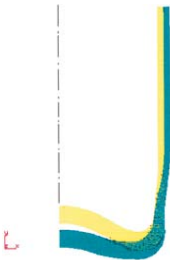
Рис. 2. Деформирование участка баллона с вогнутым дном
