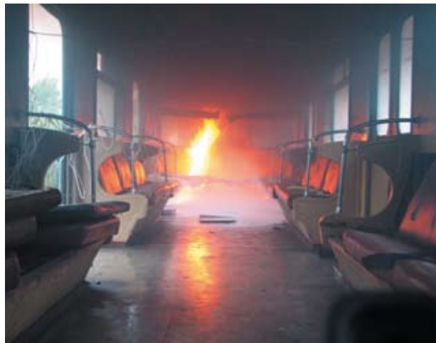
Рис. 1, б. Фрагмент опытов по тушению пожара в салоне вагона метро
