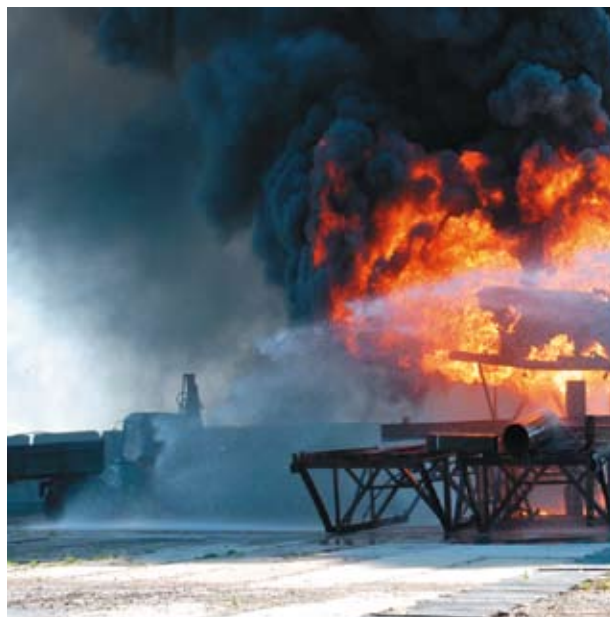
Фото 4. Расчистка устья горящей скважины при проведении практических занятий на тренажере
