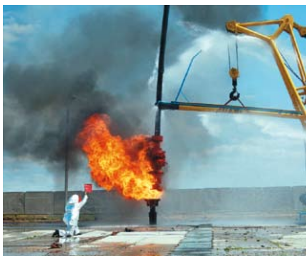
Фото 5. Наведение запорно-устьевой сборки на устье горящей скважины при проведении занятий на тренажере
