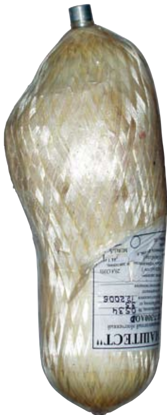
Рис. 1. Комбинированный баллон давления с обмоткой из органоровинга «Дупеета® SK75» после испытаний
