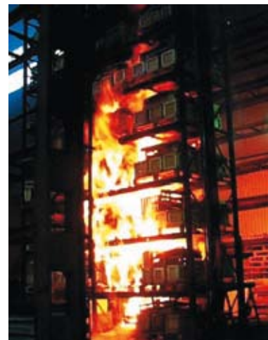
Рис. 4. Огневые испытания высотных стеллажных складов
