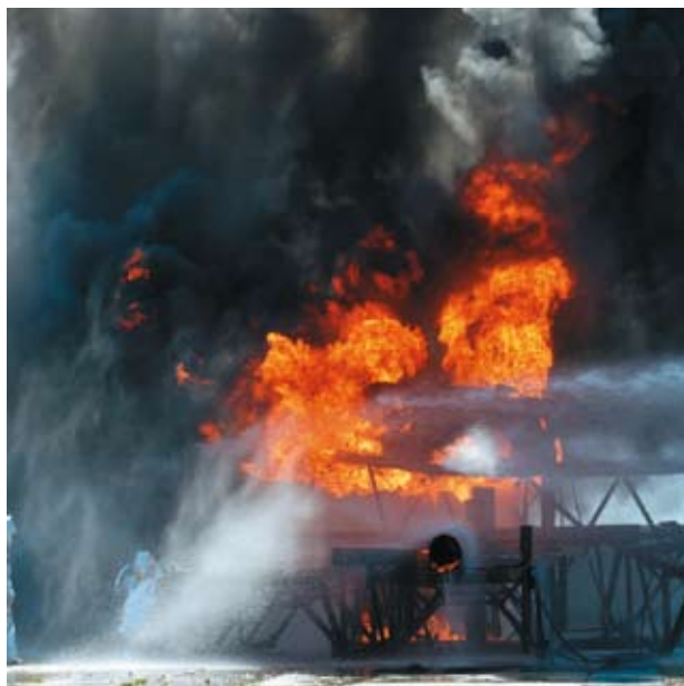
Фото 4. Расчистка устья горящей скважины при проведении практических занятий на тренажере
