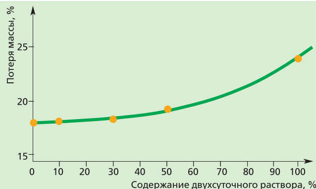
Рис. 4. Зависимость огнезащитной эффективности смесового состава «Пирол» от количества подмешанного в него двухсуточного раствора
