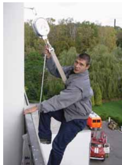
Рис. 5. Применение самоспасателя «Автоматическая спусковая система IC-301»
