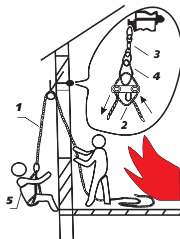
Рис. 2. Конструкция комплекта «Школа» и схема организации спуска с его использованием (обозначения в тексте)
