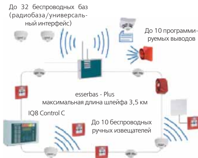
Рис. 3. Использование радиомодулей на адресных шлейфах ПС
