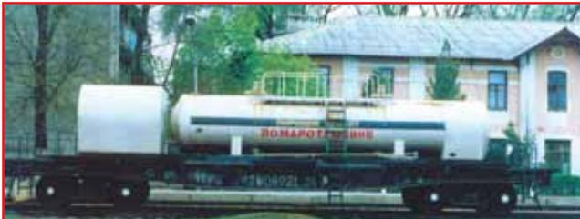
Пожарный поезд с боевым расчетом способен обеспечить подачу 15 тыс. м<sup>3</sup> пены средней кратности, ликвидировать разлив легковоспламеняющихся жидкостей на площади 1400 м<sup>2</sup>, создать охлаждение с нормативным расходом воды в течение 40 мин одновременно двух железнодорожных цистерн. С использованием стационарных и мобильных комплексов пожарные поезда могут перекачивать опасные грузы из аварийных цистерн с расходом от 90 до 200 м<sup>3</sup>/ч.
