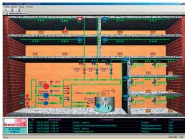
Рис. 1. Пример мониторинга и управления спринклерным пожаротушением в зданиях общественного назначения посредством SCADA-системы
