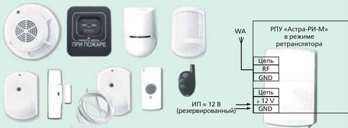
Рис. 17. Схема использования ретрансляторов в последней модификации ОПС «Астра-РИ-М»
