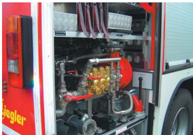
Рис. 5. Применение системы дозирования пенообразователей FireDos на пожарных автомобилях
