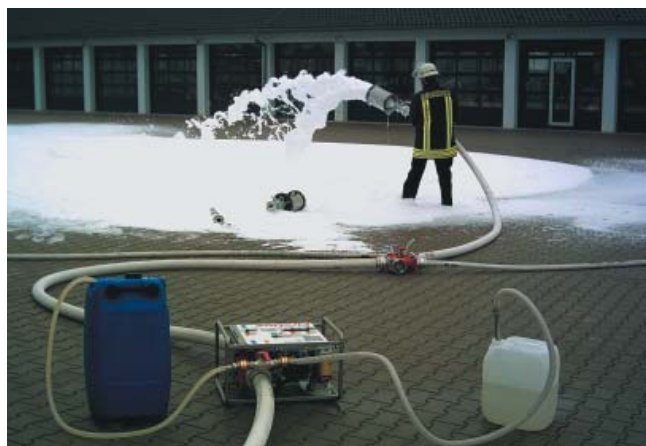
Рис. 7. Мобильная установка дозирования пенообразователей FireDos
