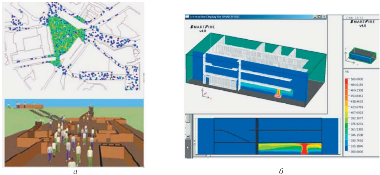
Рис. 5. Модель BuildingExodus функционирует и обменивается данными в процессе моделирования с дифференциальной моделью SmartFire (а), учитывает взаимное влияние динамики распространения опасных факторов пожара и эвакуации людей (б)
