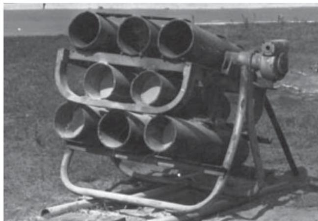
Рис. 6. Многоствольный модуль автоматизированной системы защиты для машинного зала АЭС, для технологической установки на нефтегазовой платформе, в цеху, на портовом терминале, танкере, в насосной или компрессорной станции
