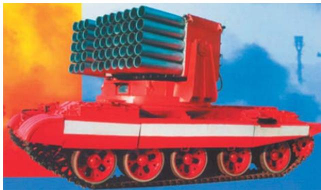
Рис. 2. Импульсная 50-ствольная башенная установка типа «Импульс-3М» на шасси танка Т-62, выпущенная в 1991 г. опытной партией (32 машины)
