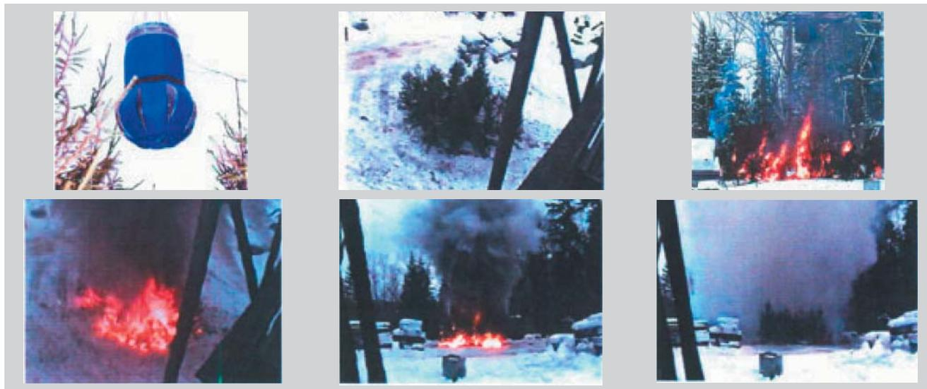
Рис. 3. Водяная бомба с пластиковым корпусом, изготовленным из стандартной пластиковой бочки вместимостью 160 л, с дном, имеющим радиальные разрезы, с высоты 10 м тушит горящий участок 250 м<sup>2</sup> соснового леса высотой до 5 м
