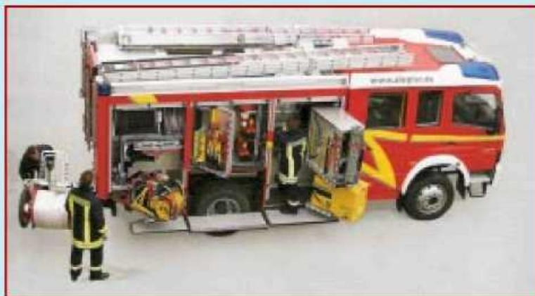
Рис. 2. Применение поворотных модулей и откидных ступенек облегчает съем оборудования, размещенного в труднодоступной зоне (автоцистерна фирмы Ziegler, Германия)
