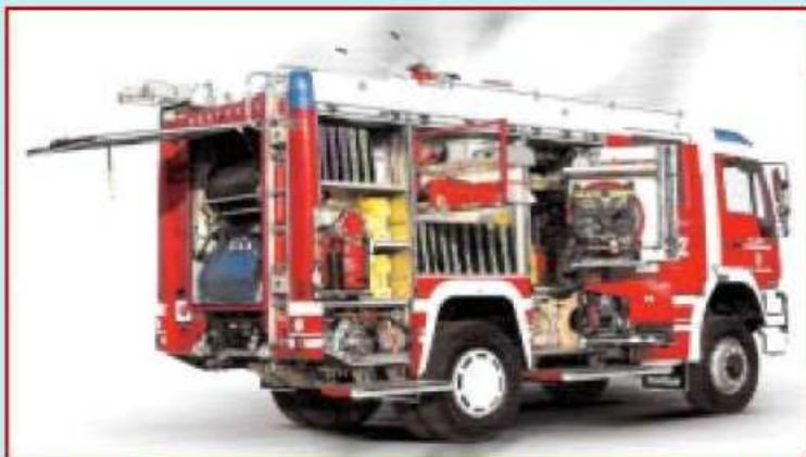
Рис. 1. Реализация принципа «суперплотной» компоновки при размещении ПТВ и оборудования на пожарной автоцистерне фирмы Rosenbauer (Австрия) с надстройкой, выполненной по алюминиевой технологии
