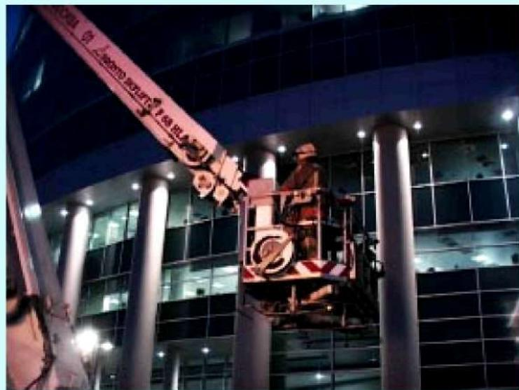
В работе коленчатый подъемник
