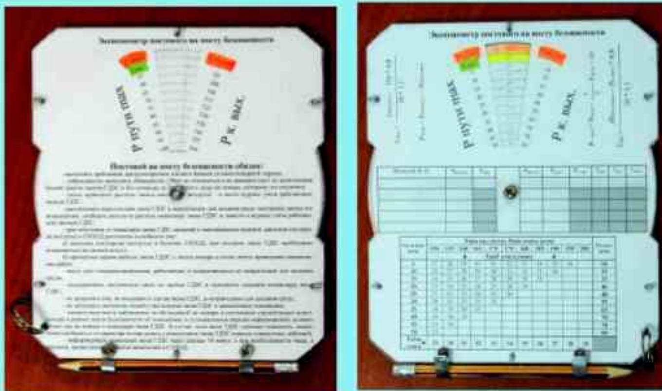
Общий вид экспонометра постового на посту безопасности ГДЗС
