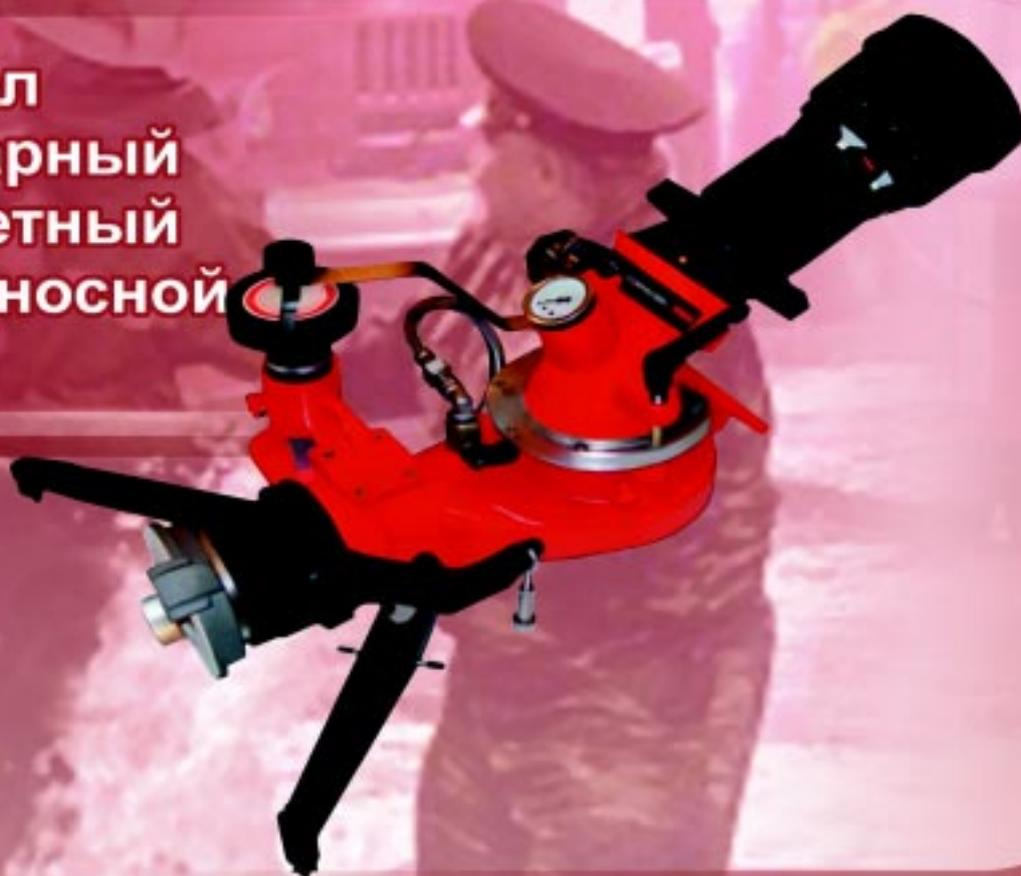
Переносной пожарный ствол СОМРАСТОР 2000 - самый мобильный и легкий в семействе высококачественных лафетных стволов французской фирмы R.Pons. Благодаря наличию осциллирующего устройства, ствол автоматически перемещается в горизонтальной плоскости на заданный оператором угол. Встроенная система защиты VSC в сочетании с дополнительными водо-пенными насадками делает ствол эффективным противопожарным средством в борьбе с огнем.
