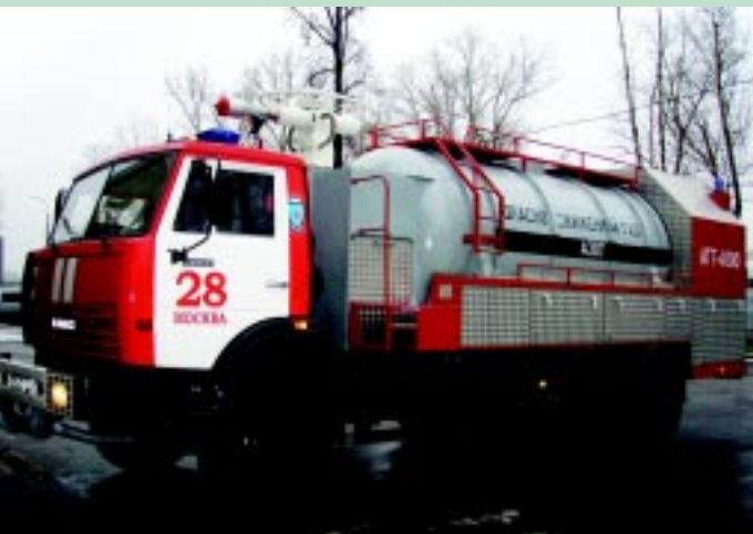
Автомобиль газового пожаротушения
