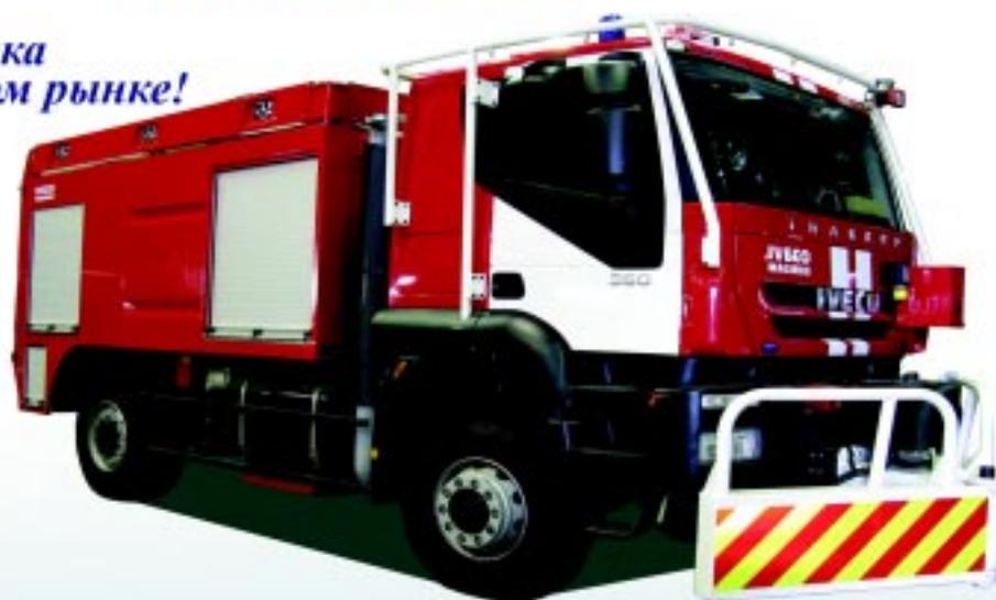
**Автомобиль предназначен для тушения пожаров в туннелях, разбора завалов и спасения людей, а также для транспортировки пожарного оборудования и оказания технической помощи**
