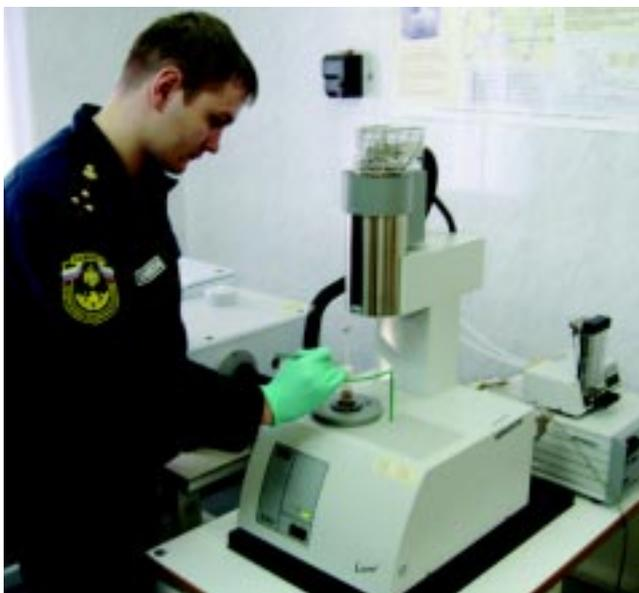
Рис. 1. Проведение термогравиметрического анализа
