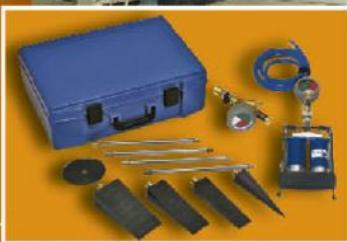
Пневматические конусные и клиновидные заглушки предназначены для оперативного устранения одним человеком утечек жидкостей и газов из поврежденных резервуаров. При помощи специальной штанги, состоящей из наращиваемых секций, можно с безопасного расстояния вставить конусные или клиновидные заглушки. Прилагаемый комплект пневматических заглушек позволяет герметизировать трещину 15-60 мм или пробоину диаметром 30-90 мм. Для накачивания пневматических заглушек используется ножной насос.
