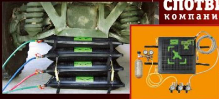
Пневматические подушки высокого давления (8,0 бар). Конструкция подушки позволяет обеспечивать равномерный подъем грузов по всей площади подушки. Изделие обеспечивает подъемную силу до 65 тонн. Комплект из трех подушек позволяет поднимать груз на высоту до 50 см
