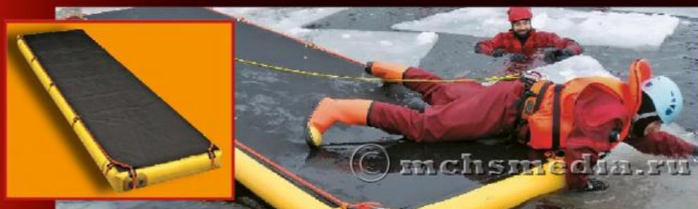
Спасательный надувной мост используется для проведения спасательных операций на воде, на льду и в заболоченных местах. Мост обладает необходимой прочностью к механическим воздействиям за счет использования покрытия на основе Kevlar. Рабочее давление 0,5 бар. Изделие поставляется длиной 5 и 10 м
