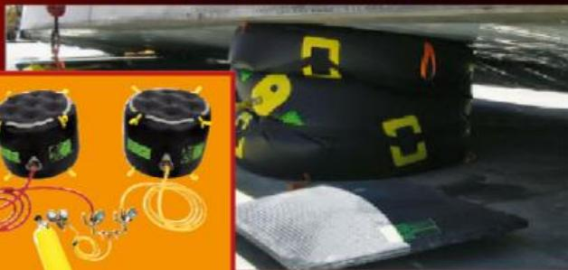
Пневматические подъемные подушки низкого (0,5 бар) и среднего (1,0 бар) давления предназначены для подъема груза до 12,0 т. на высоту до 2,0 м в тяжелых условиях эксплуатации при проведении противопожарных и аварийно-спасательных работ
