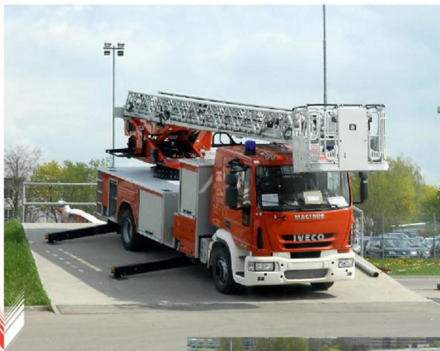
Испытание системы опор на негоризонтальной площадке
