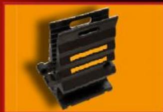
Рукавные мостки предназначены для защиты пожарных рукавов и коммуникаций (электрокабели, пневмошланги и т.п.) при прокладке через проезжую часть дороги. Конструкция мостка позволяет одновременно защищать 2 пожарных рукава диаметром до 89 мм. Мостки изготавливаются из резины и выдерживают без деформации нагрузку 10 тонн на ось. Изделие поставляется двух моделей: с шарниром в поперечной оси и без шарнира
