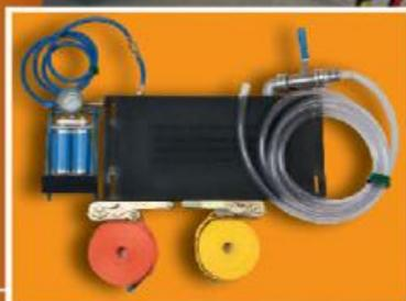
Пневматические подушки предназначены для герметизации мест утечек жидкостей и газов, находящихся под давлением в трубопроводах и резервуарах диаметром более 500 мм. Уплотнительные подушки фиксируются на поврежденных резервуарах или трубопроводах с помощью табельных натягивающих ремней и натяжных механизмов.
