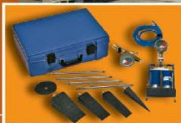
Пневматические конусные и клиновидные заглушки предназначены для оперативного устранения одним человеком утечек жидкостей и газов из поврежденных резервуаров. При помощи специальной штанги, состоящей из наращиваемых секций, можно с безопасного расстояния вставить конусные или клиновидные заглушки. Прилагаемый комплект пневматических заглушек позволяет герметизировать трещину 15-60 мм или пробойну диаметром 30-90 мм. Для накачивания пневматических заглушек используется ножной насос.
