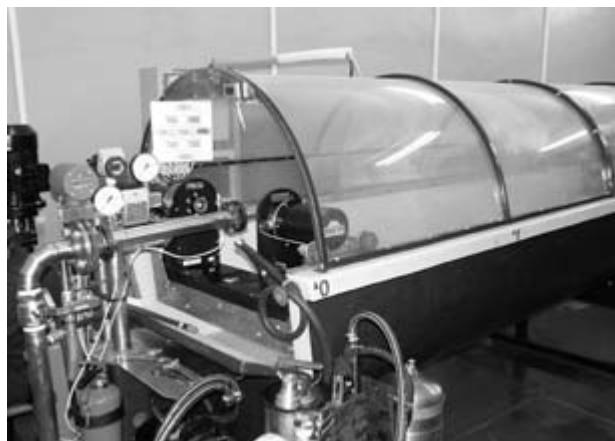
Рис. 1. Гидродинамический стенд с системой измерения размера частиц
