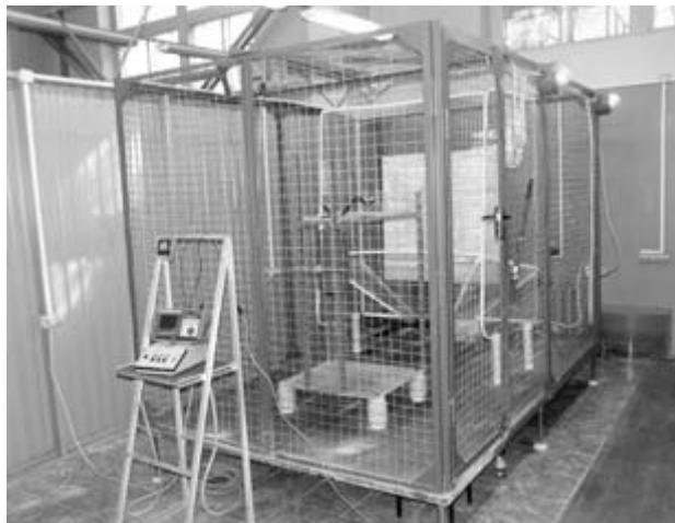
Рис. 3. Испытания огнетушителя на электростенде
