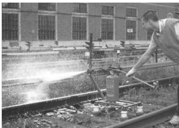
Рис. 4. Измерение тока утечки по струе ОТВ
