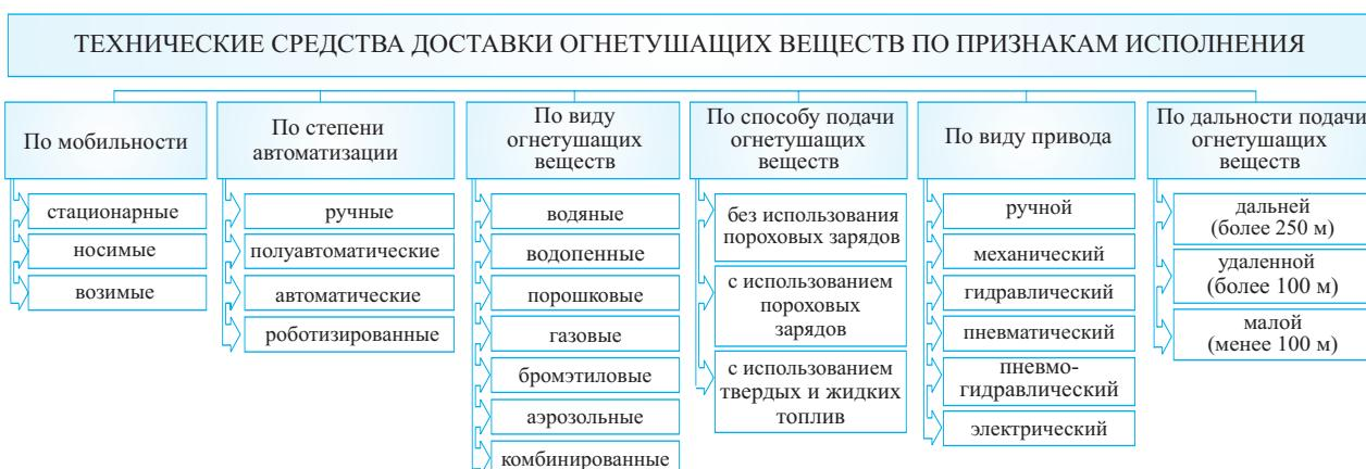
Рис. 6. Классификация технических средств доставки ОТВ по признакам исполнения
