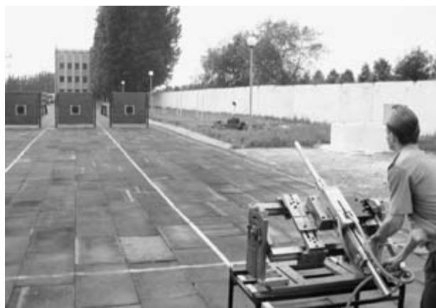
Рис. 4. Проведение испытаний опытно-экспериментальной установки пожаротушения стволовой контейнерной доставки огнетушащих веществ на расстояния более 100 м
