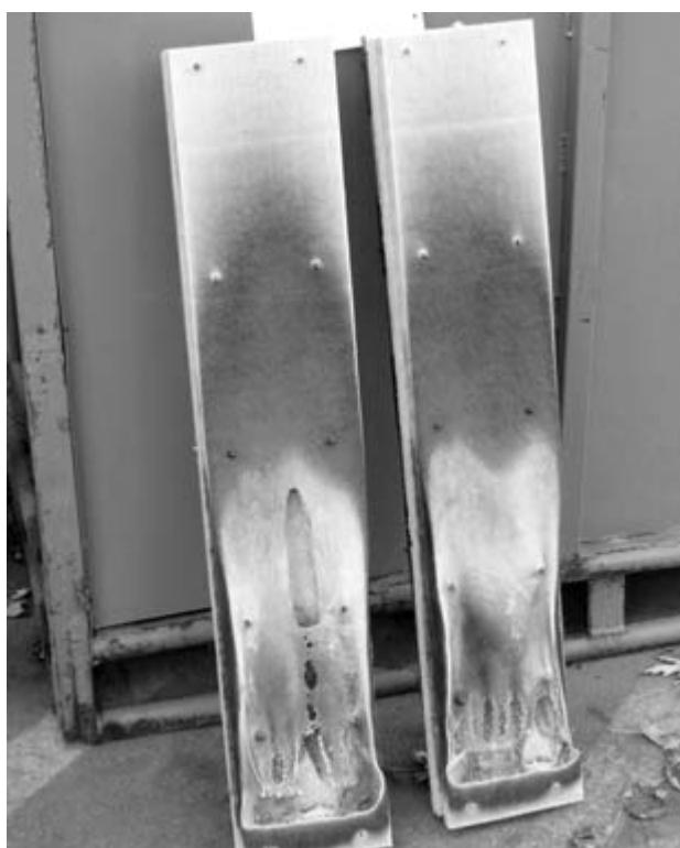
Рис. 1. Внешний вид образцов теплоизоляционного материала после испытаний
