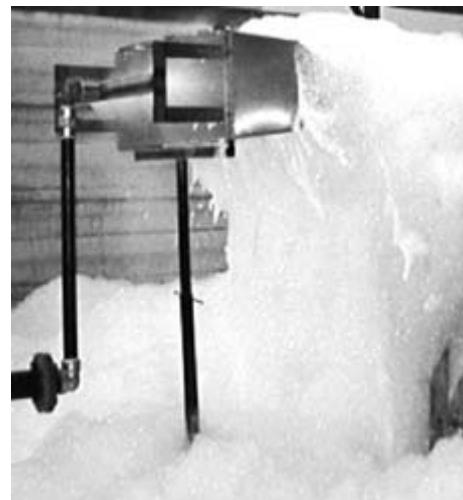
Рис. 1. Заполнение помещения высокократной пеной, полученной на генераторе, устойчивом к действию продуктов сгорания
