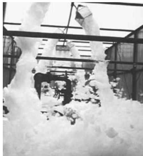
Рис. 2. Иллюстрация применения высокократной пены для тушения пожара в помещении
