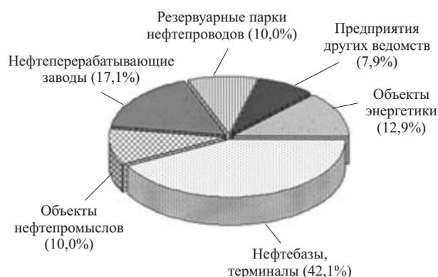
Рис. 5. Распределение разрушившихся PBC по ведомственной принадлежности
