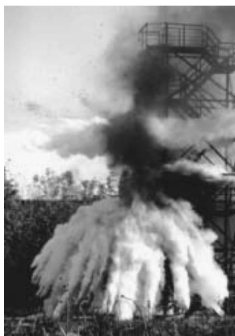
**Рис. 5.** Водяная бомба, изготовленная из стандартной пластиковой бочки, емкостью 160 л, с дном, имеющим радиальные разрезы
