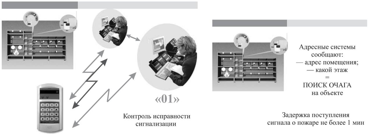
Рис. 2. Алгоритм функционирования адресной радиоканальной системы мониторинга безопасности объектов
