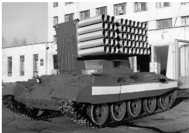
Рис. 3. Многоствольная установка на шасси танка Т-62
