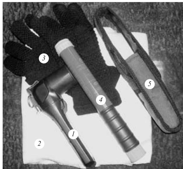
Рис. 4. Комплект снаряжения сотрудника ГПС, выполняющего функции дозорного: 1 — сертифицированный аэрозольный огнетушитель (предназначенный для тушения классов пожаров А, В, С); 2 — кошма; 3 — хлопчатобумажные перчатки; 4 — фонарь электрический индивидуальный; 5 — поясная сумка
