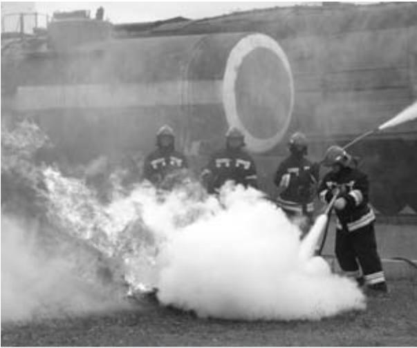
Рис. 2. Тушение горючей жидкости ТАВ
