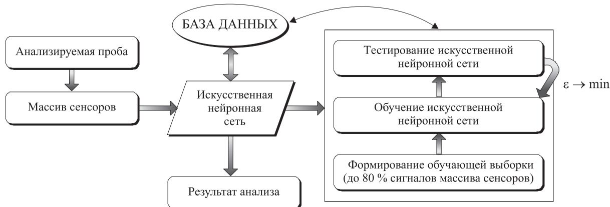
**Рис. 4.** Схема организации анализа горючих газов с использованием поверхностно-модифицированных пьезорезонаторов ( $\varepsilon$  — допустимая погрешность определений, задаваемая исследователем)
