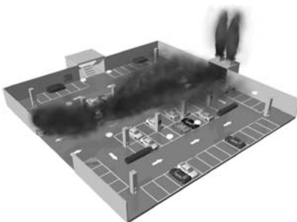
Рис. 1. Схема импульсной противодымной вентиляции
