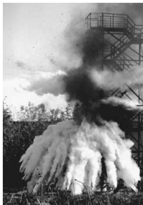
Рис. 1. Фрагмент распыления 100 кг огнетушащего порошка из подвесной “бомбы”
