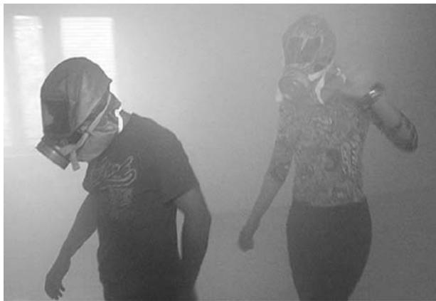
**Рис. 6.** Испытание самоспасателей в общежитии при эвакуации группами по 3 человека по задымленному участку
