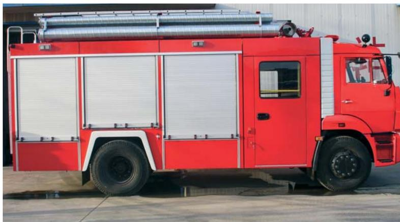
Емкости для воды и пенообразователя изготовлены из клееного стеклопластика. Емкость цистерны для воды составляет 400 л. Емкость для пенообразователя размещена внутри цистерны для воды. Срок службы цистерны 15 лет. Цистерна оборудована комбинированным пожарным насосом НЦПК -40/100-4/400 В1Т, который является эксклюзивной разработкой УСПТК, не имеющей аналогов в России и позволяющей использовать в пожаротушении тонко распыленную струю воды.
